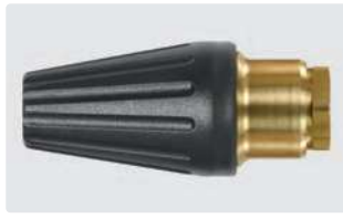
1/4" F. Spray angle 20°. 120 - 250 bar. Max. 100 °C
