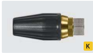
M18 F. Spray angle 20°. 100 - 250 bar. Max. 100 °C
