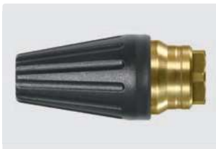
1/4" F. Spray angle 20°. 200 - 400 bar. Max. 100 °C
