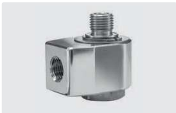
1/4" F : 1/4" M. DN 7. Max. 150 bar / 30 r.p.m. / 90 °C
